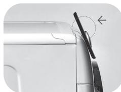
Dacă nu cunoști poziția antenei NFC, mișca circular încet telefonul deasupra logo-ului Smart Touch până când Aplicația confirmă conexiunea. Pentru ca transferul de date să se realizeze cu succes este esențial **SAȚI TELEFONUL PE MASINA ÎN CELE CĂTEVA SECUNDE ALE PROCEDURII**; un mesaj pe dispozitiv te va informa cu privire la rezultatul corect al operațiunii și îți va recomanda îndepărtarea telefonului.
